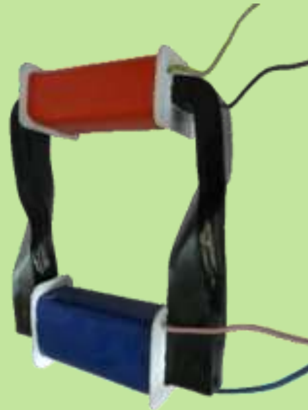
Стержневой двухкатушечный магнитопровод с топологией лист Мебиуса
