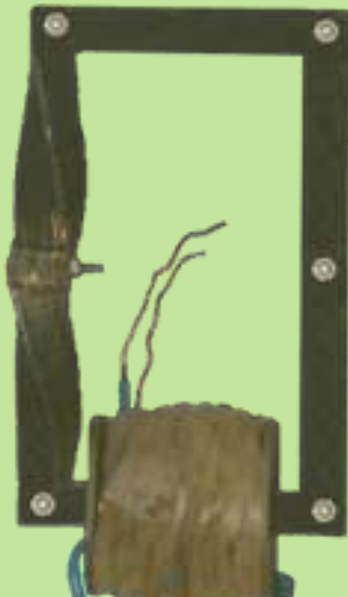
Стержневой магнитопровод с топологией лист Мебиуса
