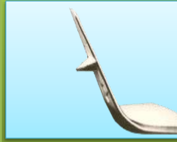
Концевые поверхности с вихрегенератором типа «Зуб»
